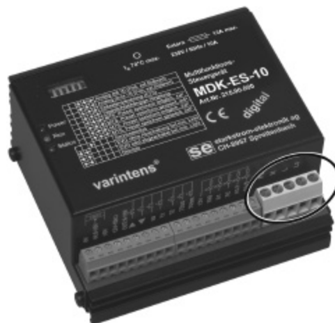
Fig. 2 - 1 Restgefährdungspotential durch Berührung mittelspannungsführender Anschlüsse (230 VAC)
