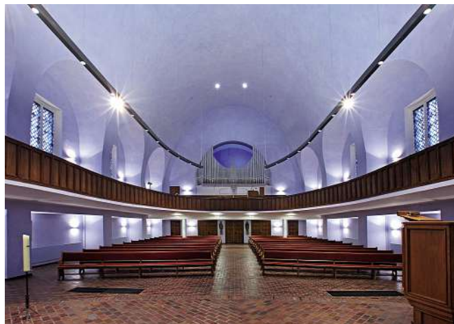
Bild 3: Im Zuge der Renovierung wurden die Kronleuchter durch zwei schlanke Lichtprofile ersetzt; das Kirchenschiff wurde in ein sanftes Blau getaucht
