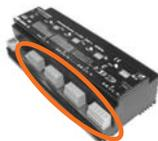
Restgefährdungspotential durch Berührung mittelspannungsführender Anschlüsse (230 VAC). Bei bestimmungsgemäsem Einsatz des UDK-04-10 (KNX) sind alle massgebenden Normen und Vorschriften zur Vermeidung von Personen- und Sachschäden eingehalten. Restgefährdungen durch spannungsführende Anschlüsse sind jedoch nicht vollständig auszuschliessen. Die wichtigsten Bereiche mit Restgefährdungspotential sind in nebenstehender Figur dargestellt.
