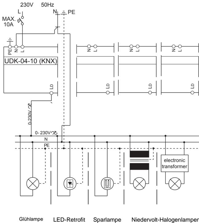
Der 4-fach Universal-Dimmer ist in der Lage, 230V Glühlampen, Niedervolt- Halogenglühlampen in Verbindung mit **elektronischen oder magnetischen Transformatoren** oder Motoren bis zu einem Maximalstrom von 2.5 A (570 W) anzusteuern. Die gedimmte Spannung ist am Ausgang "LD" verfügbar. Der Universal-Dimmer regelt die Ausgangsspannung mit Hilfe von Transistoren.
