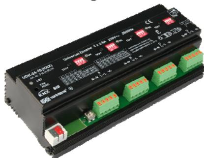
Der 4-fach Universal-Dimmer ist für alle gängigen dimmbaren Leuchtmittelarten geeignet. Es stehen 4 getrennte Dimmer-Eingänge und -Ausgänge zur Verfügung, die je mit 570W belastbar sind. Die Regelkreise erkennen automatisch die angeschlossene Last und schalten dementsprechend automatisch von Abschnitt- auf Abschnittstechnologie um und steuern das Leuchtmittel mit einer geeigneten Steuerkennlinie (Ueff) an.
