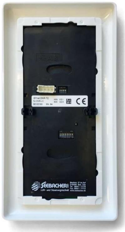
Steckverbinder: Phönix PTSM 4-polig steckbar
